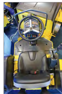
Ergonomischer, vibrationsfester Sitz mit Sicherheitsschalter
