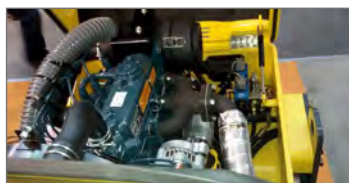
Der geradlinig verbaute Kubota-Motor bietet einfachen Betrieb und hervorragende Wartungszugänglichkeit
