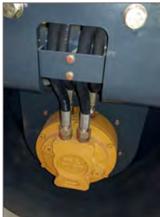
Schmierstellen an jeder Walze Poclair-Antriebsmotoren
