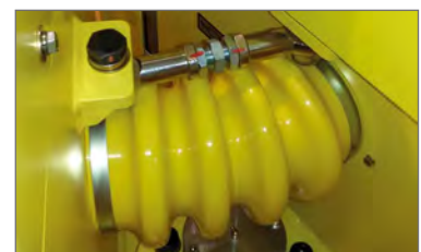
Doppelgelenk mit Schmierstellen, Pac-pivot (patentiert)
