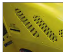
Motorhaube aus Glasfaser
