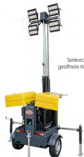
Verstellbare Stützen (Breite und Position) zur Anpassung an den Boden
