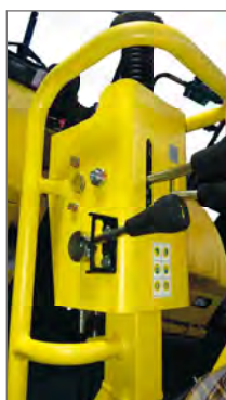
Steuerpult mit umschaltbarer Amplitude
