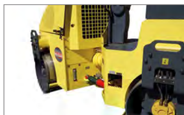
Doppelgelenk mit Schmierstellen, Pac-pivot (patentiert)
